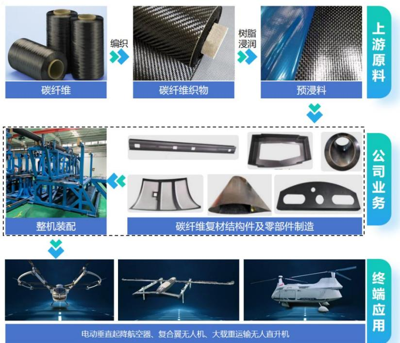
图 3 碳纤维复材机构件及零部件制造与整机装配终端应用
