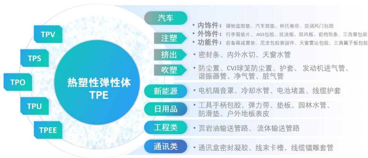
图 2 热塑性弹性体终端应用
