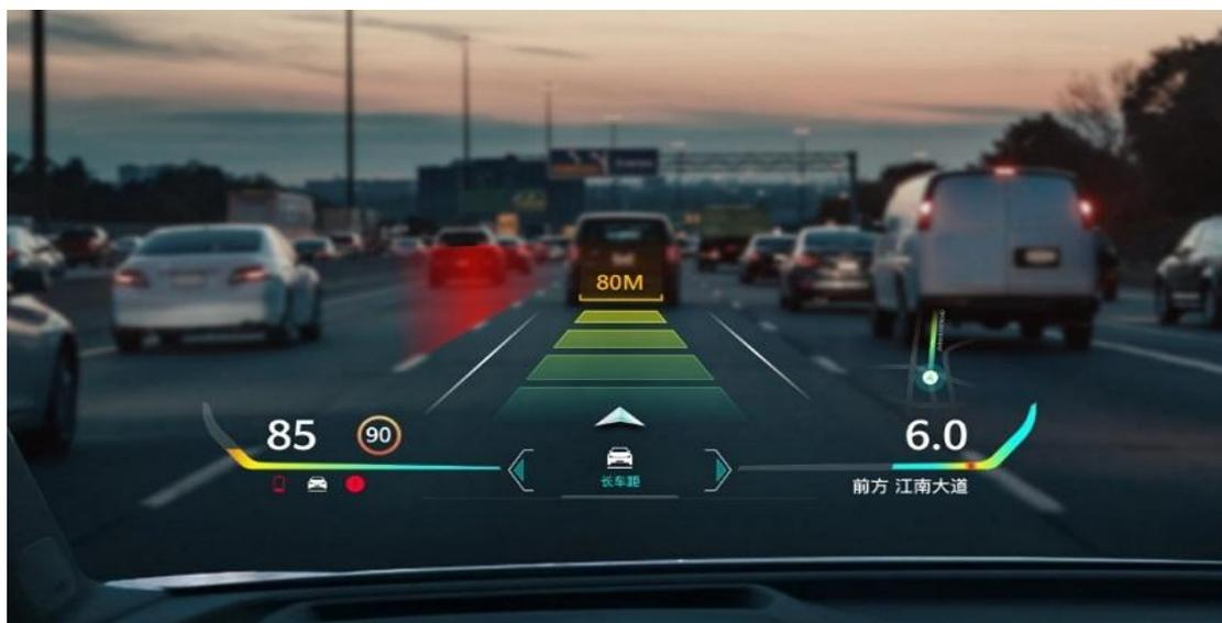
公司还提供对赋能 HUD 应用至关重要的 LCOS 产品。HUD 通过将信息直接投影至用户的视野内，通常是在透明及反光的表面上，为便利驾驶员操作及驾驶安全提供更强支持。在汽车 AR-HUD 的应用方案上，LCOS 作为反射式投影技术，与目前主要应用的 DLP 方案相比有着更好的透光率及更高的耐热性，能保证更好的性能从而也能更好的保护驾驶员的安全。随着 LCOS 技术的不断成熟，目前公司 LCOS 产品已在汽车 AR-HUD 方案中实现量产交付。
